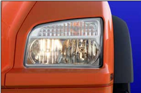
*Les phares halogènes à réflecteur complexe offrent la performance d'éclairage d'un système de réflecteur à faisceaux parallèles sans coût supplémentaire. Conçus avec des lentilles en polycarbonate extra épais et un inhibiteur de rayons UV, les phares résisteront à plusieurs années de service sans aucun problème.*
