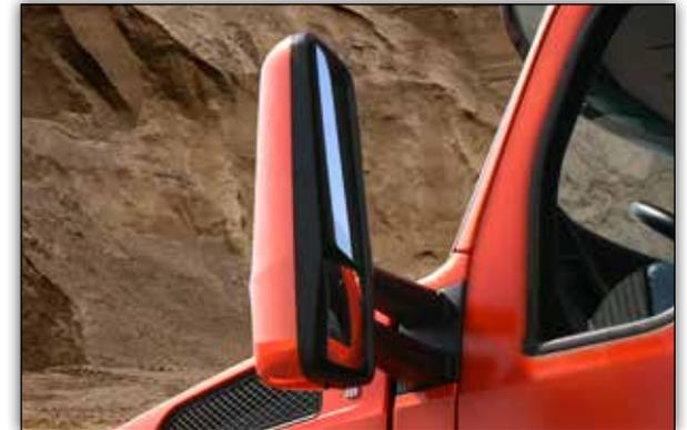
*Les rétroviseurs latéraux aérodynamiques durables sont montés sur le cadre de la cabine pour une meilleure stabilité et sont situés plus vers l'avant et plus bas afin d'optimiser la visibilité vers l'arrière. La portion convexe est 37 pourcent plus large que le design standard de rétroviseur convexe de Kenworth.*
