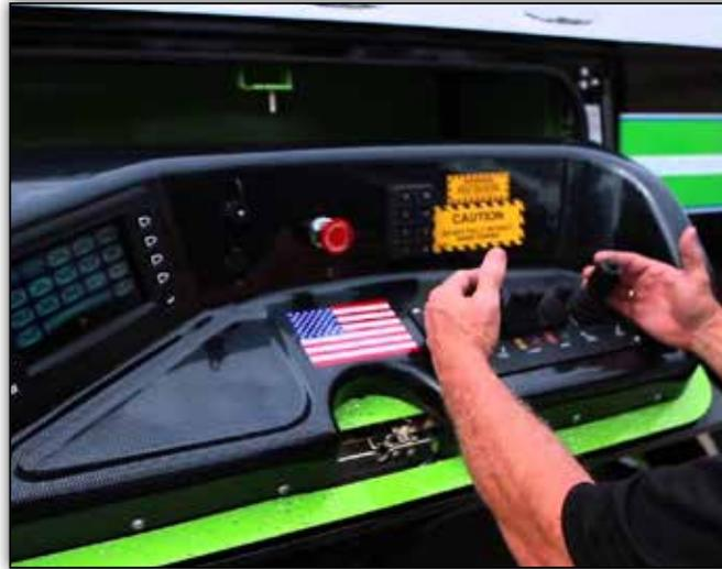
*La configuration et le contrôle des fonctions de votre prise de force n'ont jamais été aussi faciles. La programmation définie par l'utilisateur permet au moteur et à la prise de force d'être réglés en fonction d'une opération maximale quel que soit le chargement. Les contrôles de la prise de force sont situés dans la cabine et peuvent aussi être situés à distance sur le châssis. Ils leur est également possible d'opérer jusqu'à deux prises de force.*
