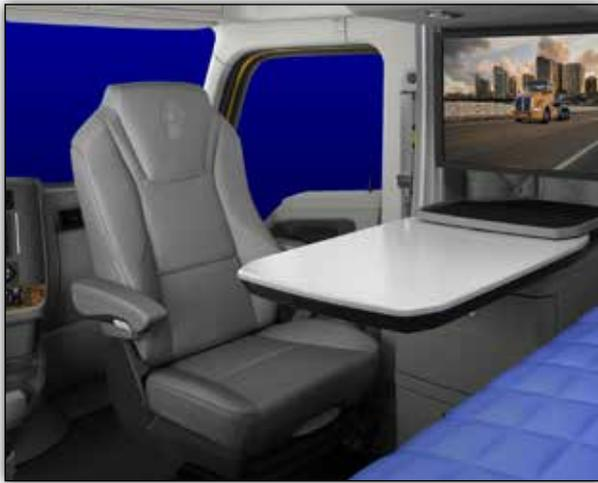
*Le Studio du chauffeur comprend l'ensemble d'un siège du passager pivotant à 180°, et d'une table pivotante, ce qui maximise l'espace vital du chauffeur en combinant la cabine et le compartiment-couche dans un vaste studio, permettant au chauffeur de relaxer confortablement dans le siège du passager plutôt que d'être confiné uniquement dans le compartiment-couche arrière. Ceci permet également de regarder la télévision à partir du siège du passager ou de la couche.*
