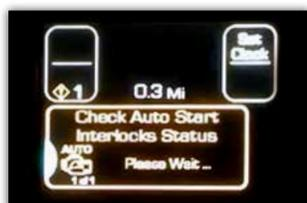
*Le système démarre automatiquement le moteur si la charge des batteries est trop faible ou si le moteur devient trop froid, puis éteint le moteur lorsque les conditions sont revenues aux paramètres préétablis – une façon intelligente de gérer les exigences de charge au repos sans laisser tourner le moteur du camion au ralenti inutilement.*
