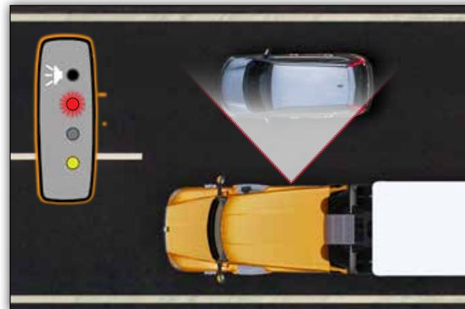
Le système de détection d'objet dans les zones latérales surveille continuellement les angles morts du camion et fournit au chauffeur des alertes sonores et visuelles lorsqu'un objet ou un véhicule se présente dans ces zones – inestimable lors d'un changement de voie ou de livraisons dans des sites restreints.
