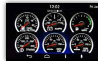
Les jauges virtuelles pré-chargées comprennent la température de l'huile, la température de la transmission, l'indicateur de pression du turbo, l'économie de carburant actuelle et moyenne, le statut du DPF ainsi que le couple du moteur.
