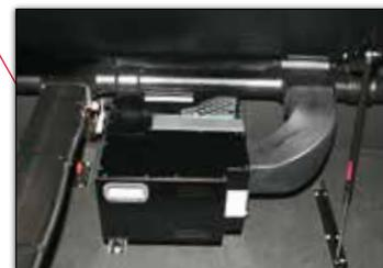
*L'assemblage compact du compresseur DC et de l'évaporateur sans balai est stratégiquement situé dans l'aire de rangement du compartiment-couchette.*
