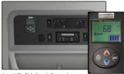
*Le contrôle d'interface de l'utilisateur à affichage LCD commodément situé sur le panneau de contrôle du compartiment-couchette offre un contrôle automatique de la température à la fois en modes air climatisé et chauffage.*
