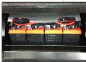
*Quatre batteries de groupe 31, isolées électriquement du camion, alimentent le système.*
