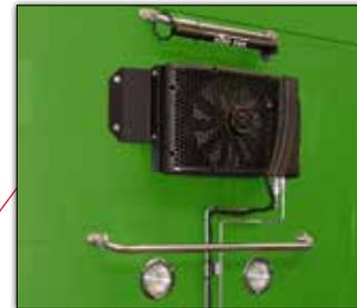
*Le condensateur distant avec assemblage de ventilateur sans balai est installé centralement sur le mur supérieur extérieur pour une performance optimale.*
