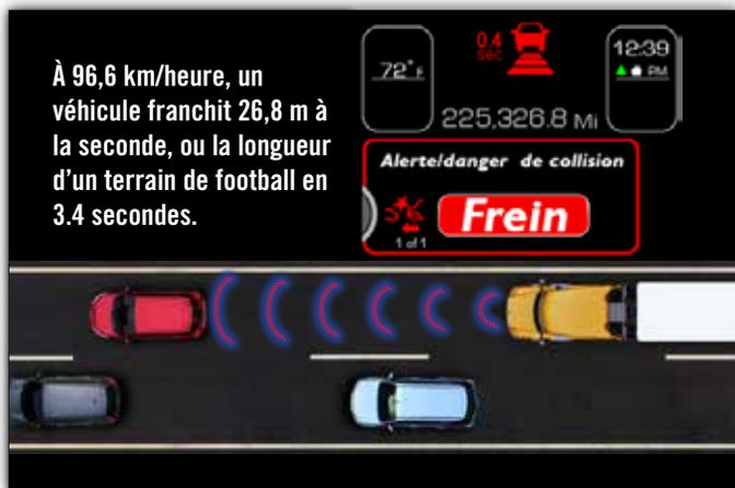
Bien plus qu'un vague système d'avertissement, l'atténuation de collision de Kenworth détecte le moment où le camion est susceptible d'entrer en collision avec un autre véhicule ou un objet, alerte le chauffeur et active une action préventive de freinage – au besoin – afin d'éviter un accident ou d'en réduire considérablement la gravité.
